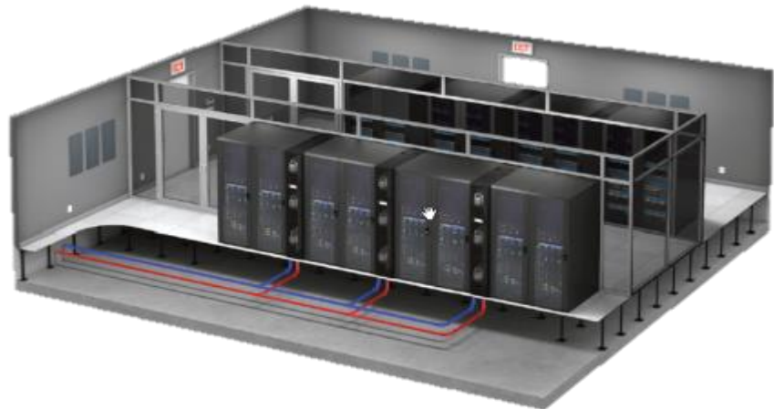
热量由液冷系统直接带到机房外
